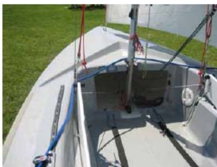
Foto zeigt Ixylon FUN mit verlängerten Genuaschiene
